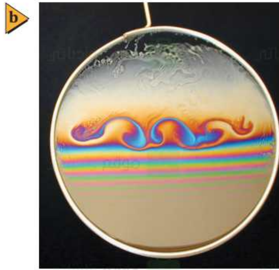
■ الشكل 6-7 يحدث تقوية لكل طول موجي عندما يكون سُمك غشاء الصابون 5\lambda/4, 3\lambda/4, \lambda/4 (a). ولأن كل لون له طول موجي خاص به فإن سلسلة الأهداب التي تنعكس عن غشاء الصابون تكون ملونة (b).
