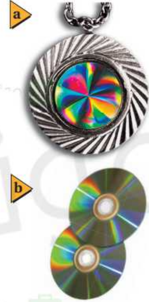
الشكل 7-12 جوهرة مصنوعة في صورة محزوز نفاذ تنتج أطيفاً ضوئية (a). تعدّ الأقراص المدمجة محزوزات انعكاس؛ إذ تكوّن نمط طيف الحيود عندما يسقط عليها ضوء أبيض (b).
