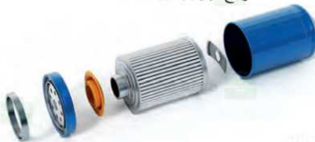
شكل 2.19: عرض تفصيلي لتجميع مرشح الزيت
