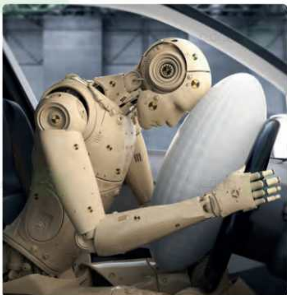
شكل 2.8: اختبار التصادم باستخدام دمية ثلاثية الأبعاد
