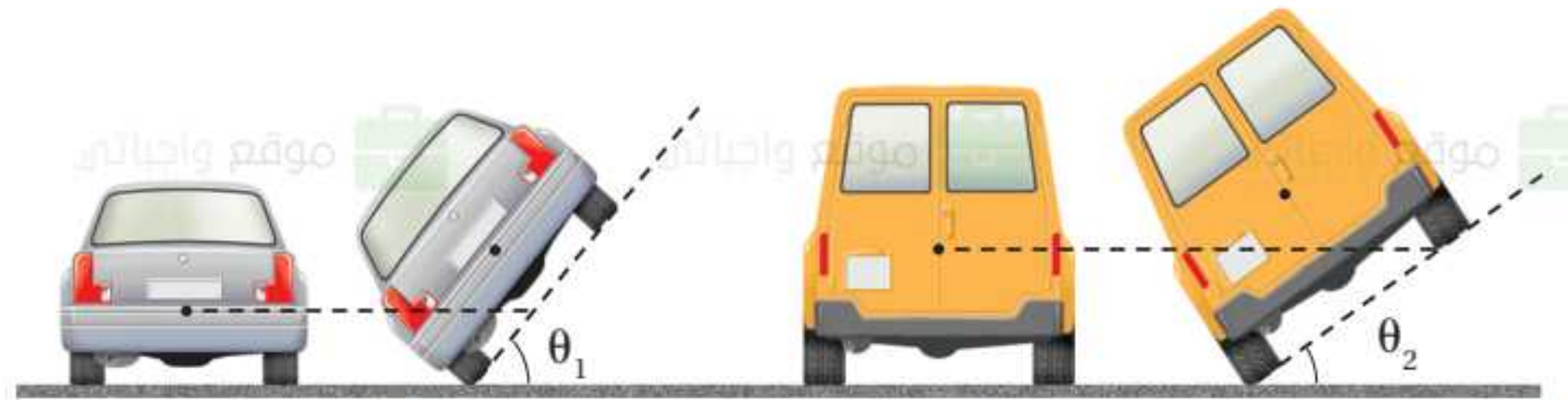
الشكل 11-2 مركز كتلة السيارة الصفراء أعلى من مركز كتلة السيارة الرمادية. وكلما كان مركز كتلة السيارة مرتفعًا احتجنا إلى ميل أقل لجعله يتحرك خارج القاعدة مسببًا انقلابها.
