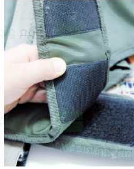
تستعمل ألياف النايلون في صناعة أشرطة التثبيت.
